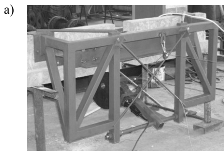
Rys. 3a. Widok urządzenia do zdalnego, kontrolowanego przecinania cięgien sprężających oraz konstrukcji wzmacniającej pas dolny b. Widok przeciętych drutów pierwszego kabla
